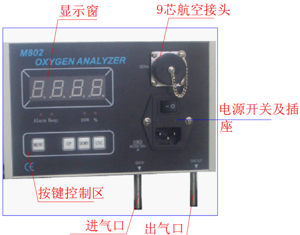
图 4 M802 面板结构示意图
