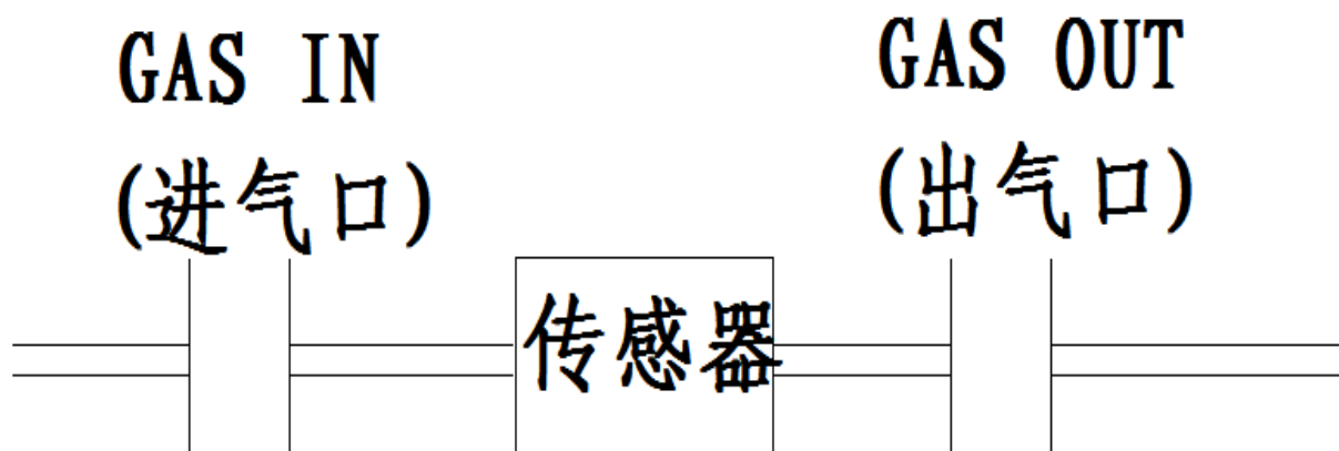
图 3 仪器内部气路连接示意图
